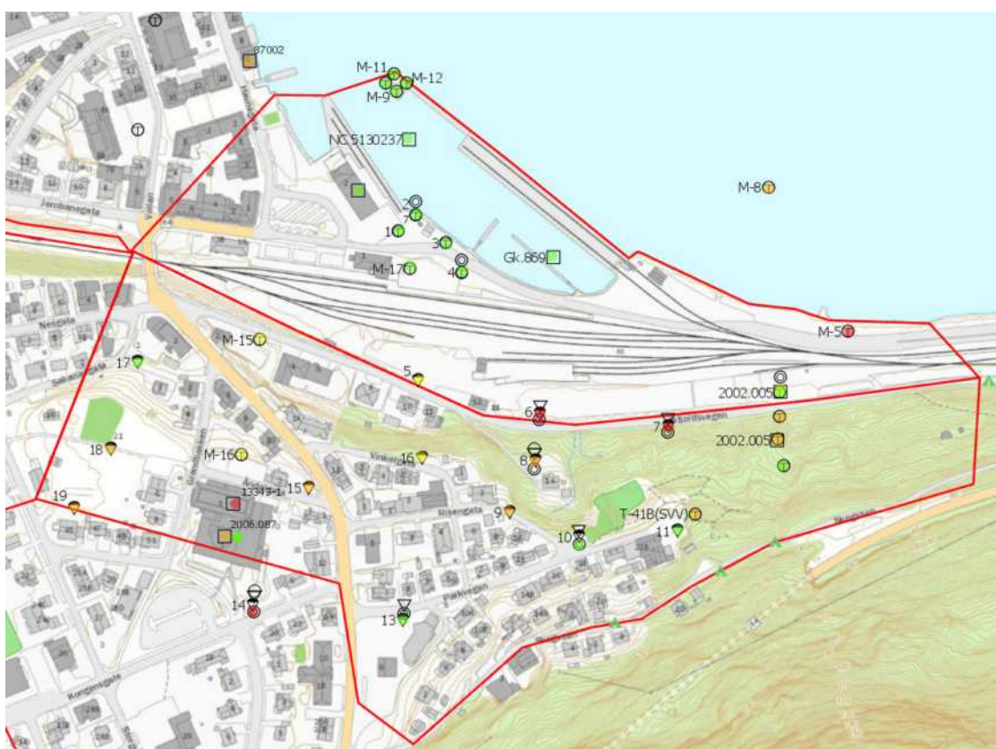
Figur 4 Plan detaljerte grunnundersøkelser. Fargekode borer: Grønt – ikke kvikkleire, gult - mulig kvikkleire, oransje – antatt kvikkleire og rødt – påvist kvikkleire (prøver)
