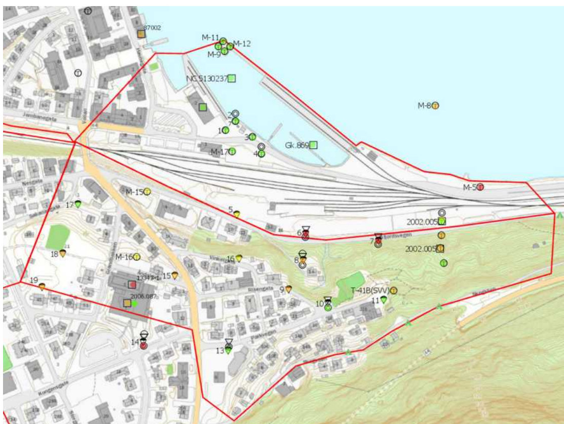
Figur 3 Plan detaljerte grunnundersøkelser. Fargekode boringer: Grønt – ikke kvikkleire, gult – mulig kvikkleire, oransje – antatt kvikkleire og rødt – påvist kvikkleire (prøver)
