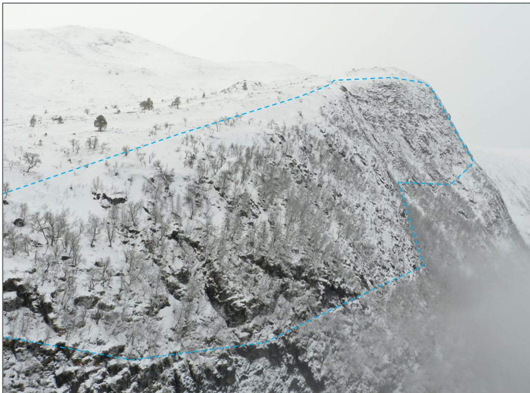
Figur 23 Dronebilde av øverste del av fjellsiden, ved ca. 650-750 moh., som viser potensielle løснеområder for hyppigere og mindre snøskred i blå stiplet polygon. Bilde tatt mot øst/sørøst.
