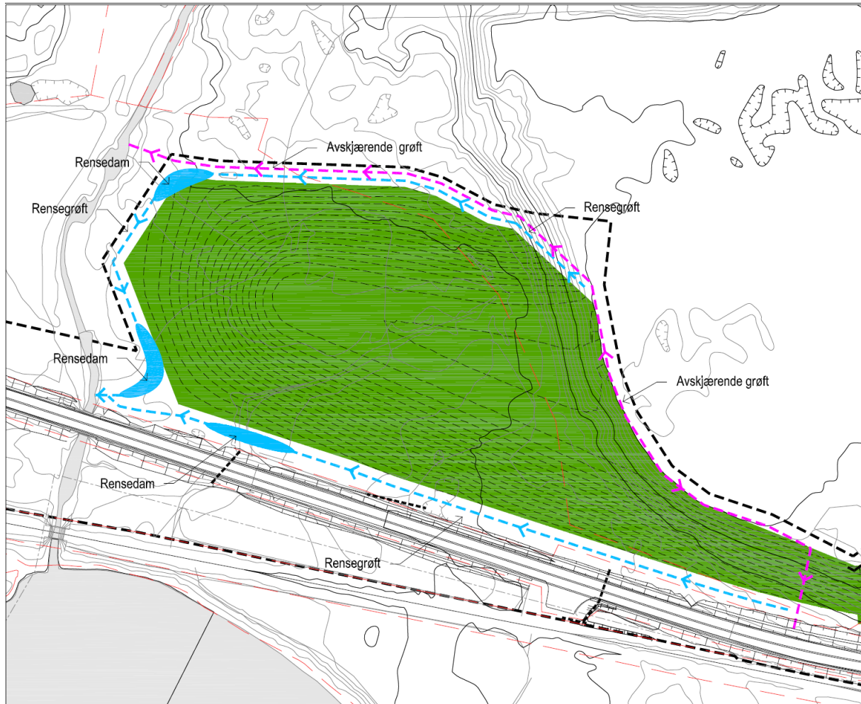
Figur 5-1: Skisse over rensetiltak – masselager Monge. Blå stiplet strek viser rensegrøft i nord og vest som renner ned i rensedam i sørvest før utløp til Mongeelva. Rensegrøft i sør ledes fra øst til vest og ut i rensedam som også har utløp i Mongeelva. Lilla stiplet linje viser avskjærende grøfter eller voll i nord og øst som ledes utenom masselageret. Piler i tegningen viser strømningsretning for vannet.
