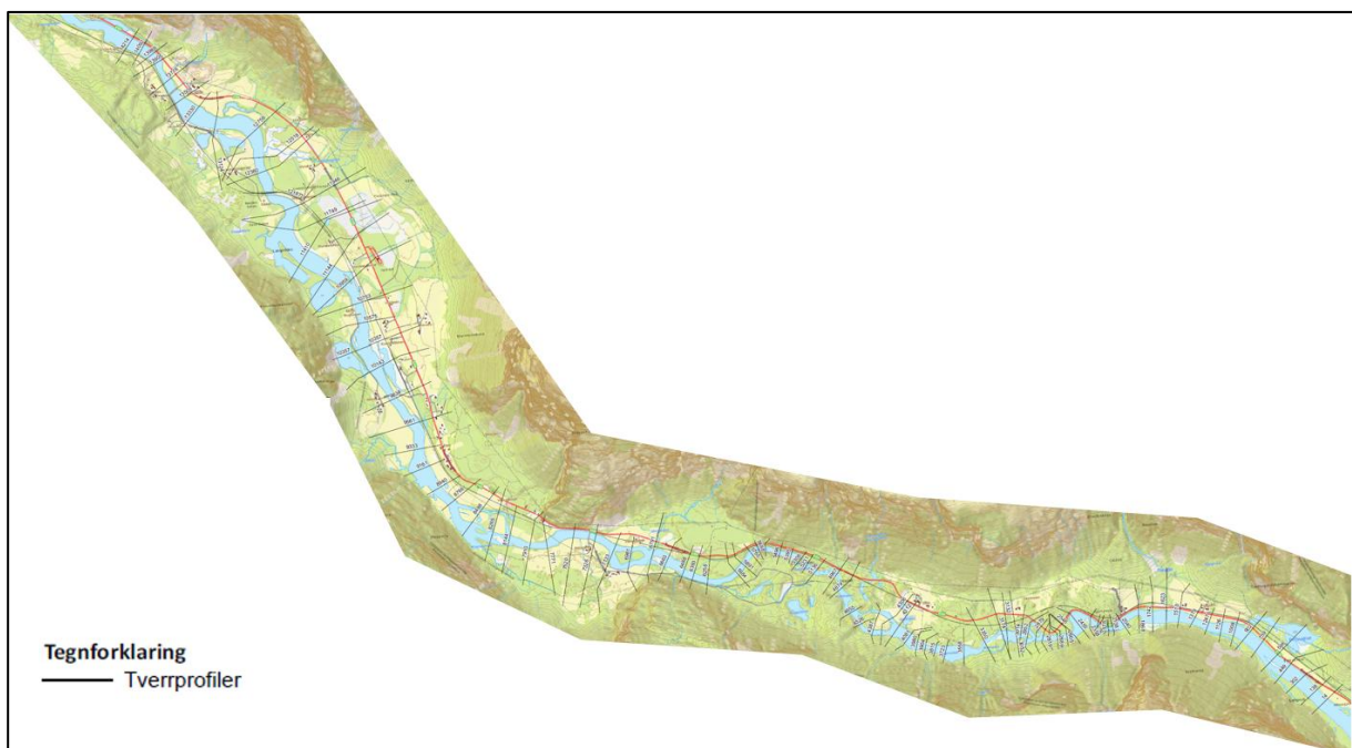
Figur 6-3 Tverrprofiler som inngår i Multiconsults (2021) 1D modell i Mike11 for Rauma mellom Flatmark-Horgheim.
