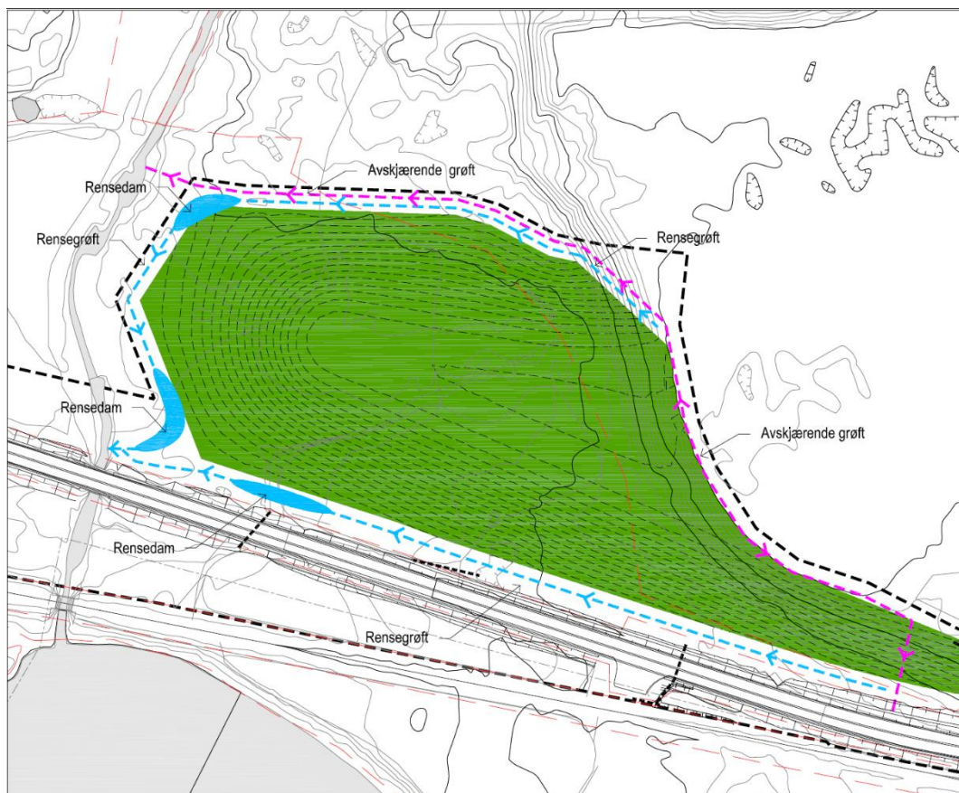
Figur 6-4: Plantegning med koter for massehåndtering Monge. Det er satt av 15 m til kantvegetasjon som skal være uberørt langs Mongeelva, samt 8 m bredde til rensetiltak. Det skal etableres rensegrøfter og rensedammer i område avsatt til rensetiltak. I tillegg må terrengvann fra oppstrøms område avskjæres og ledes til Mongeelva. Terrengvann skal ikke ledes gjennom masselageret, Sidebekk til Mongeelva som blir gjenfylt av masselageret, må tømmes for vann før oppstart masselager. Utløp til Mongeelva må også stenges slik at ikke partikler renner rett ned i Mongeelva ved deponering.
