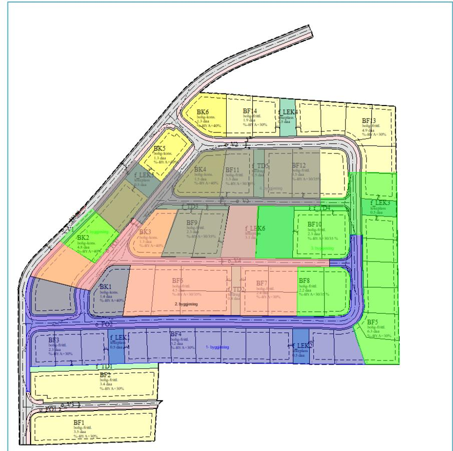
Figur 21 Framlegg til utbygging av byggjesteg. 1. byggjesteg synt med blå markering, 2. byggjesteg synt med raud farge, 3. byggjesteg synt med grøn farge, 4. byggjesteg synt med grå farge, og siste byggjesteg er utan farge.
