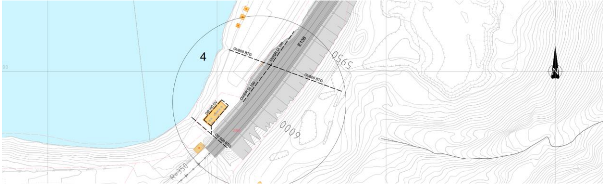
Utsnitt 14 viser utsnitt fra VA-tegning. Tiltak kulverter. Område 4 ved Innfjordtunnelen. Kilde: Ledningskart
