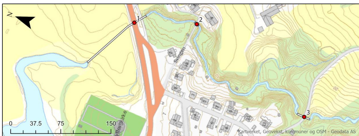
Figur 4-1 Kart som viser vanngjennomløp (kulverter) i Setnesgrova.
