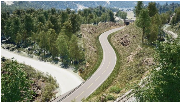
Figur 5-26 Illustrasjon av veiskjæring gjennom Kjerkjeura.
