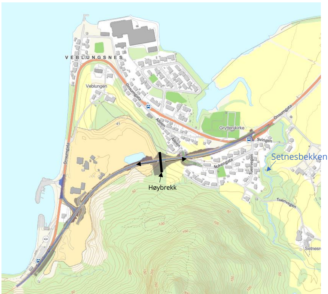
Figur 9. Foreslått veitrase gjennom Veblungsnes. Kartet viser høybrekket på veien hvor pilene angir avrenningsretning for overvannet fra veien. Kart fra kartportal: App Veblungsnes 2D 3D internt (arcgis.com) .
