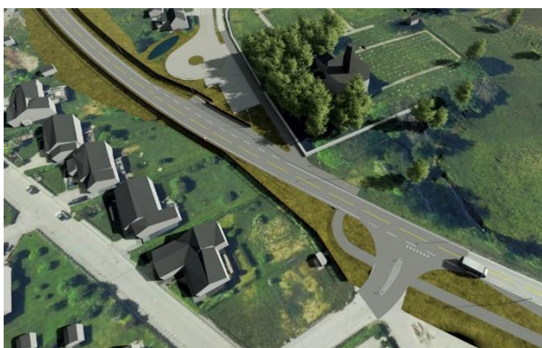
Figur 17 Planlagt t-kryss Tuenveien.
