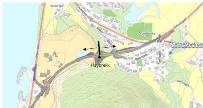
Figur 35 Kartet viser høybrekket på veien hvor pilene angir avrenningsretning for overvannet fra veien.
