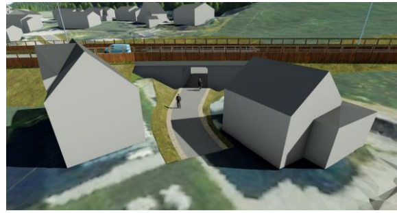
Figur 21 Ny gang-/sykkelvei med kulvert under E136. Sett fra Alleen (vest).
