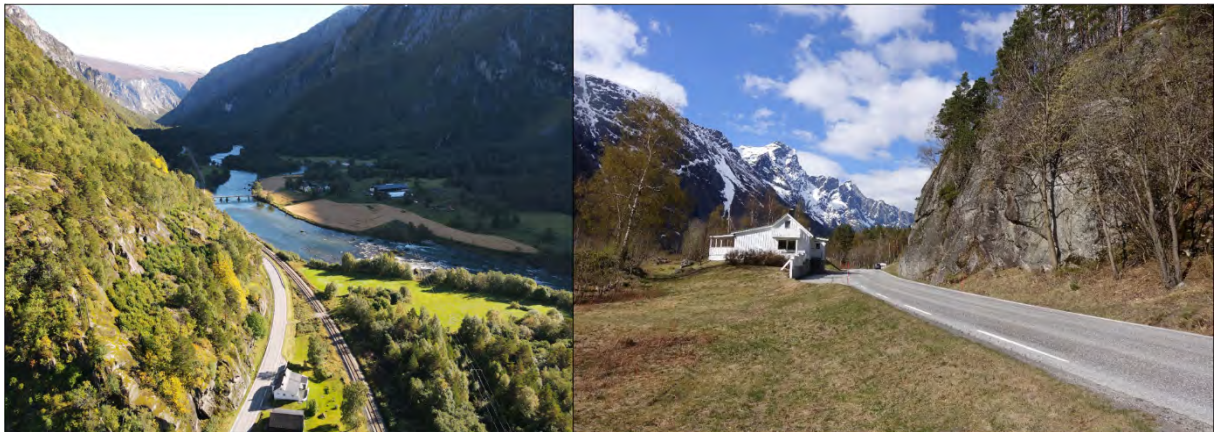
Figur 33: Venstre foto: Dronefoto tatt mot øst. I nedre venstre bildehjørne kan det observeres svaberg og ingen åpenbare løснеområder for steinsprang. Foto til høyre viser nedre del av svaberget ned mot dagens veg ved ved profil 24600 (Foto: AVV).
