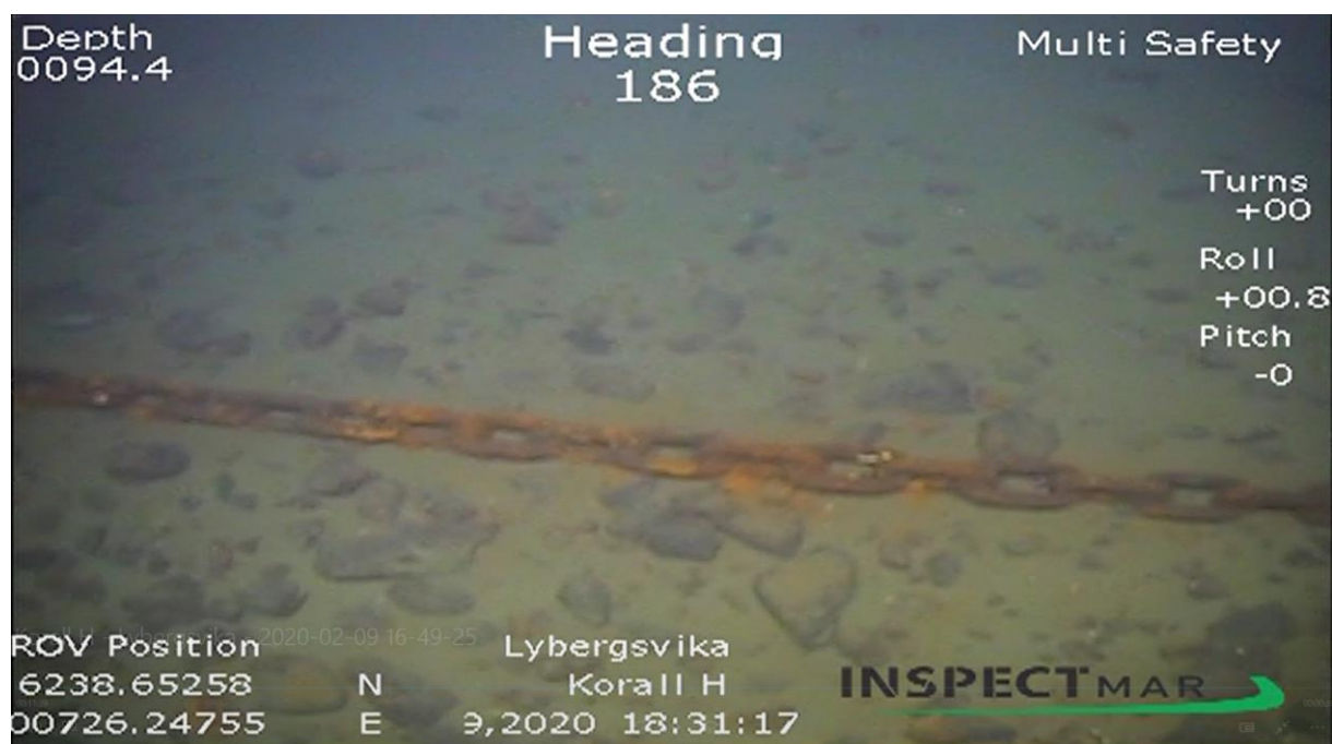
Figur 3.1.6.3 Fortøyning fra dagens plassering av anlegget på en noe mer steinete bunn.
