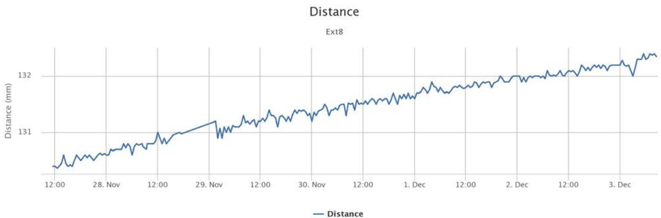
Figur 6. Rørsler frå strekkstag 8 mellom fast fjell og den øvre fjellblokka. Målingane er frå dei siste 6 dagar.
